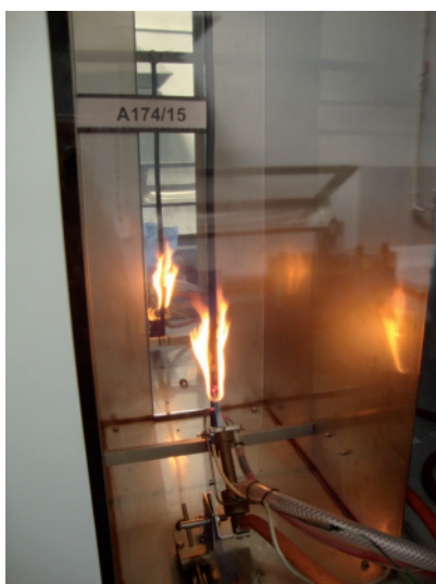
Rys. 3. Pojedynczy przewód elektryczny w trakcie testu [fot. I. Tarka]
