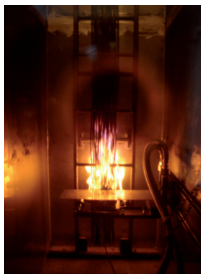
Rys. 4. Wiązka kabli poddawana badaniu na rozprzestrzenianie się płomienia [fot. I. Tarka]
