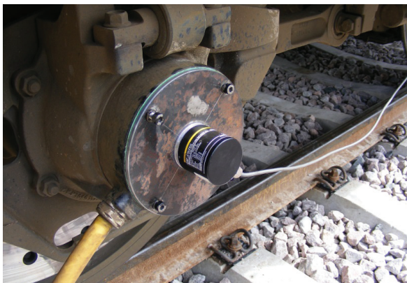
Rys. 2. Przykładowy montaż enkodera na osi jezdnej lokomotywy pomiarowej [fot. K. Tchórzewski]
