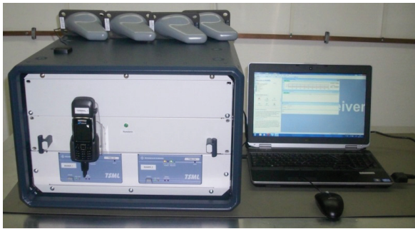
Rys. 1. System pomiarowy pokrycia radiowego [fot. K. Tchórzewski]
