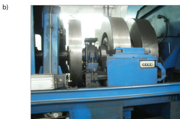
Rys. 2. Stacjonarne stanowisko badawcze: a) widok ogólny, b) mechaniczne masy zamachowe [fot. J. Kukulski]
