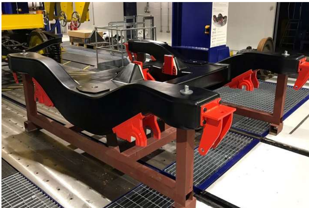
Rysunek 13 Kompozytowa rama wózka na bazie stalowej konstrukcji Alstom klasy 180 [50]
