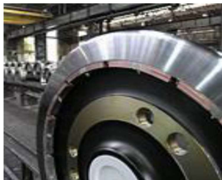
Rysunek 16 Płytowy tłumik hałasu koła [53]
