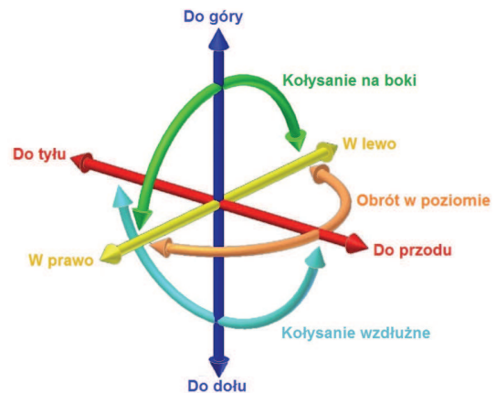
Rys. 1. Odzworowanie ruchu o 6 stopniach swobody (6DOF) [4]
