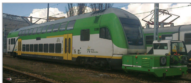
Rys. 1. Widok ogólny pojazdu szynowo-drogowego typu CRAB 3100E podczas wykonywania pracy manewrowej z wagonem Kolei Mazowieckich [fot. P. Winciorek]
