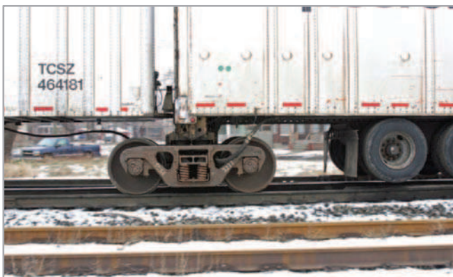
Rys. 2. Połączenie naczep z wózkiem w systemie Roadrailer (USA) [10]
