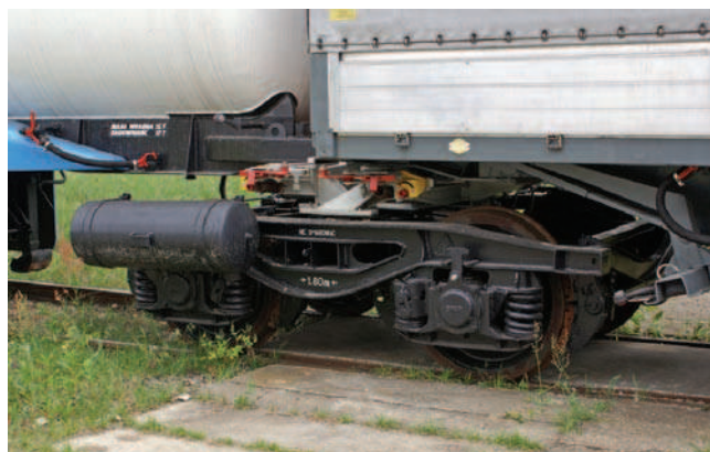
Rys. 1. Wózek pośredni z adapterami służącymi do mocowania dwóch naczep bimodalnych [13]
