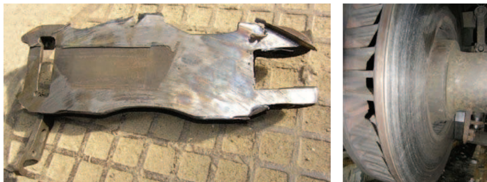
Rys. 10. Obsada hamulcowa bezpośrednio współpracująca z tarczą hamulcową (po wypadnięciu okładzin ciernych) [fot. P.Tokaj]
