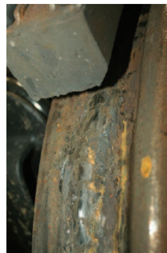
Rys. 8. Nalep powstały podczas jazdy z zahamowanym hamulcem postojowym [fot. P. Tokaj]
