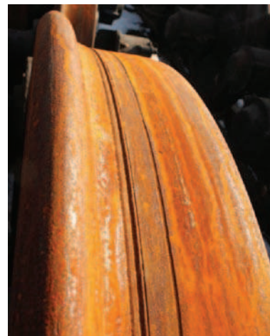
Rys. 9. Przegrzany zestaw kołowy z wyżłobieniami powstałymi podczas jazdy z zahamowanym hamulcem ręcznym [fot. P. Tokaj]
