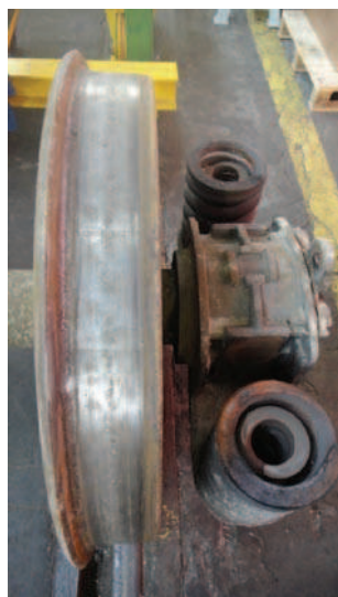
Rys. 2. Koło o nadmiernym zużyciu [fot. A. Zbieć]
