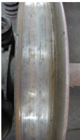
Rys. 1. Koło o prawidłowym charakterze zużycia [fot. A. Zbieć]
