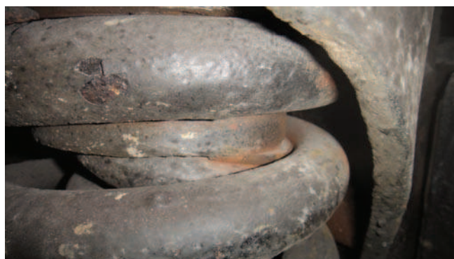
Rys. 6. Nieprawidłowo osadzona sprężyna wewnętrzna [fot. A. Zbieć]
