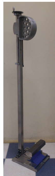
Rys. 4. Wzorcowanie przyrządu do pomiaru wysokości osi zderzaka nad główką szyny na stanowisku do badania przyrządów [fot. A. Aniszewicz]
