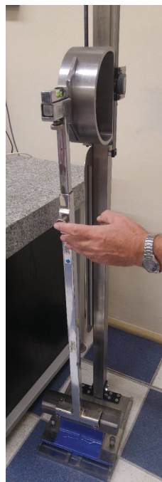
Rys. 3. Widok stanowiska do badania przyrządów do pomiaru wysokości osi zderzaka nad główką szyny [fot. A. Aniszewicz]
