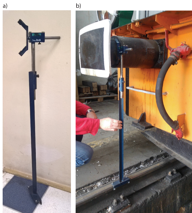
Rys. 2. Przyrząd pomiarowy do pomiaru wysokości osi zderzaka nad główką szyny: a) widok przyrządu, b) przyrząd podczas pomiaru [fot. A. Aniszewicz]
