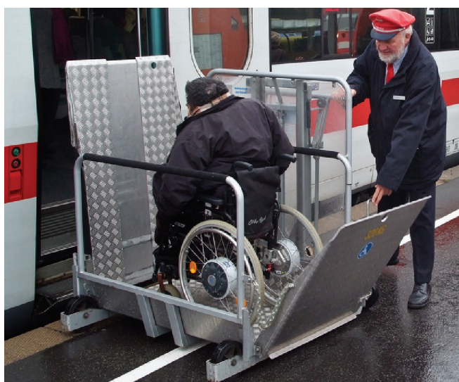
Rys. 2. Podnośnik peronowy z napędem ręcznym ułatwiający wejście do pociągu [4]
