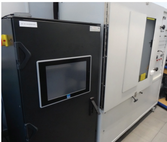
Rys. 2. Stanowisko badawcze do określania toksyczności gazów według EN-EN 45 545 2:2013+A1:2015 [1] [fot. archiwum Laboratorium]
