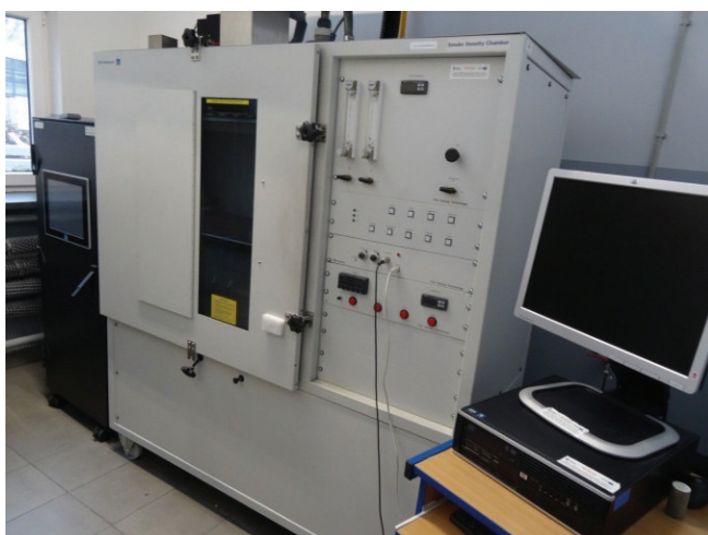
Rys. 1. Stanowisko do oznaczania gęstości optycznej dymu metodą testu jednokomorowego według PN-EN ISO 5659-2 [fot. archiwum Laboratorium]
