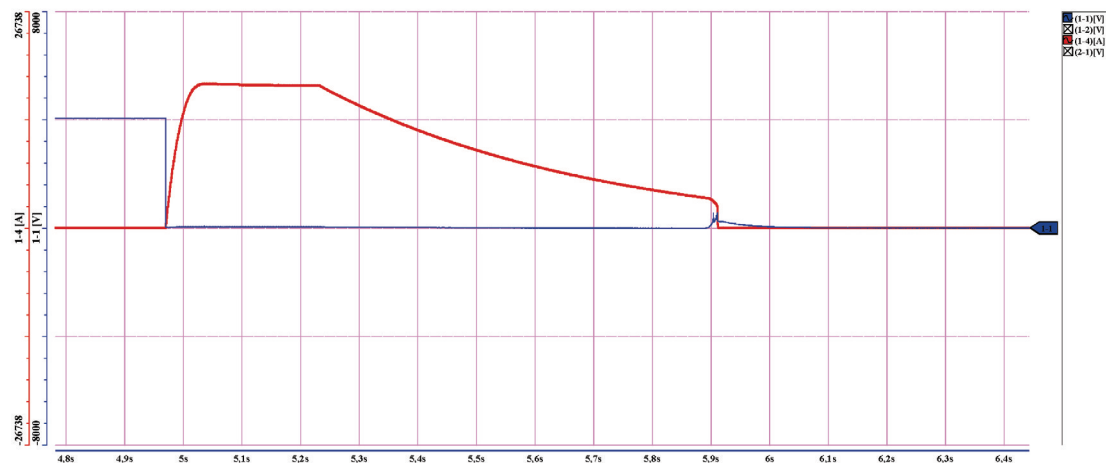
Rys. 20. Oscylogram prądu i napięcia podczas próby wytrzymałości zwarciowej na zwarcie jednokrotne, przy R_{pz} \approx 0 \Omega , wyłączane przez wyłącznik mocy — napięcie wyjściowe prostownika, — prąd wyjściowy prostownika [5]
