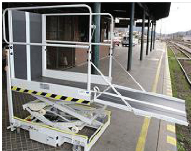
Rys. 2. Widok podnośnika peronowego ułatwiającego dostęp podróżnego na wózku do pociągu [2]
