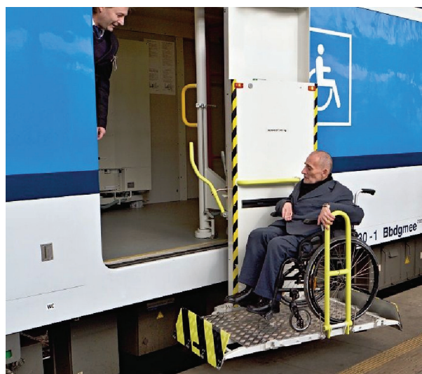
Rys. 3. Przykład podnośnika instalowanego w wagonach kolei czeskiej [8, 9]
