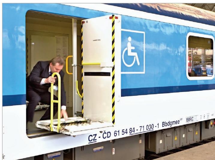
Rys. 3. Przykład podnośnika instalowanego w wagonach kolei czeskiej [8, 9]
