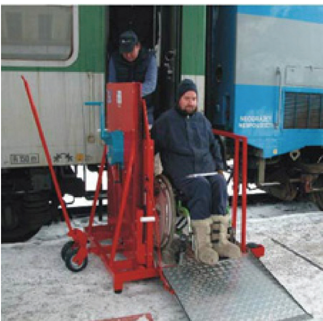
Rys. 1. Podnośniki peronowe stosowane przez koleje czeskie: [5–7]
