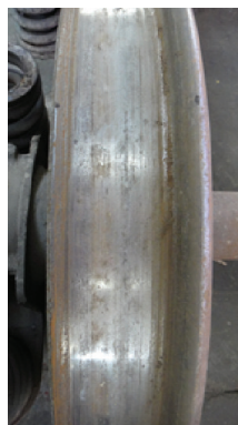
Rys. 1. Koło o prawidłowym charakterze zużycia (typowe zużycie eksploatacyjne) [fot. A. Zbieć]
