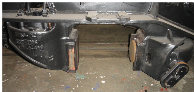
Rys. 6. Prowadzenie maźnicy wózka Y25 z widocznym, po prawej stronie, grzybkiem ciernym i ogniwnkiem [fot. A. Zbieć]
