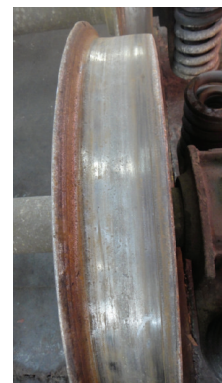
Rys. 2. Koło o nieprawidłowym charakterze zużycia (nadmiernie podcięte obrzeże) [fot. A. Zbieć]
