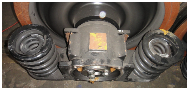
Rys. 7. Maźnica i zespół sprężyn wózka Y25 [fot. A. Zbieć]
