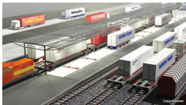
Rys. 11. Fragment terminalu transportu intermodalnego wykorzystującego podsystem CargoBeamer [18]
