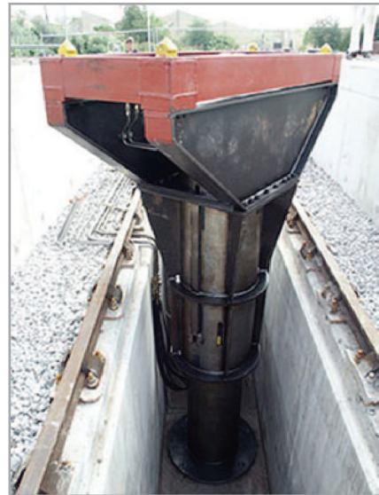
Rys. 8. Zabudowany w torze ładunkowym, maksymalnie wysunięty mechanizm obrotu części ładunkowej wagonu podsystemu CargoSpeed [15]
