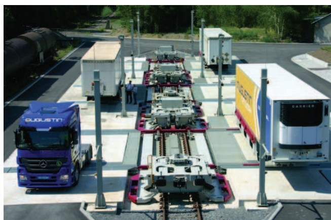
Rys. 10. Widok doświadczonego frontu ładunkowego, przystosowanego do obsługi wagonów w podsystemie CargoBeamer [16]
