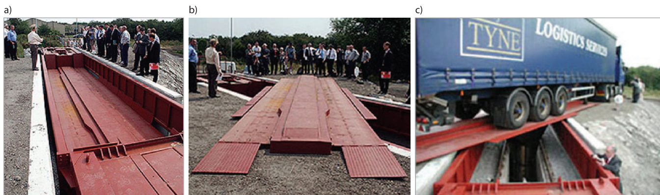
Rys. 9. Technologia załadunku pojazdu drogowego na wagon podsystemu CargoSpeed [15]: a) wagon na torze ładunkowym, b) element ładunkowy przygotowany do wjazdu pojazdu drogowego, c) umieszczenie naczepy siodłowej na elemencie ładunkowym wagonu
