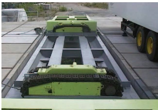
Rys. 1. Wagon z transporterami podsystemu ALS na stanowisku przeładunkowym [9]
