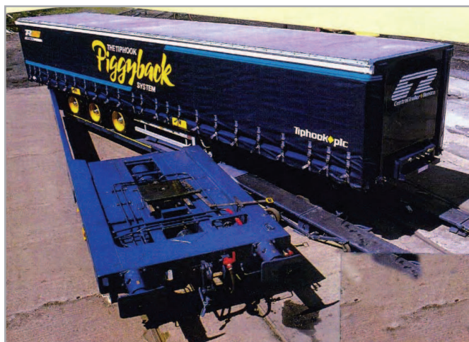
Rys. 4. Rozłożona część ładunkowa wagonu podsystemu Tiphook [13]
