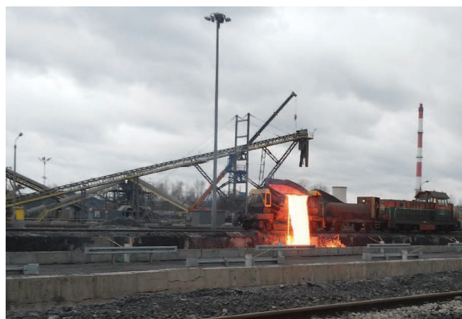
Rys. 3. Kadziowóz starszej konstrukcji podczas odstawy płynnego żużla na pole zalewowe [fot. P. Winciorek]
