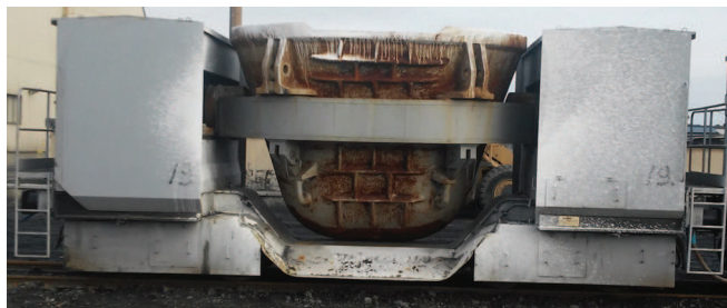
Rys. 2. Widok ogólny wagonu towarowego typu GRANT01A z osłonami [fot. P. Winciorek]
