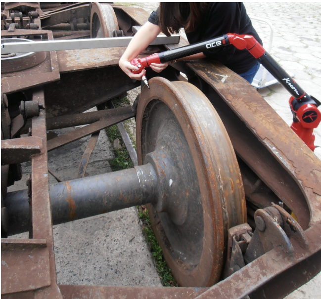
Rys. 2. Pomiary wózka jezdnego i zestawu kołowego – tarcz kół jezdnych [fot. A. Aniszewicz]
