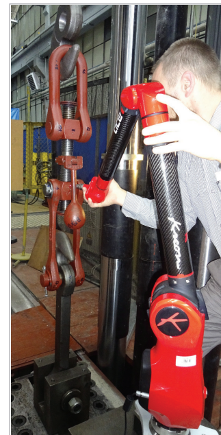
Rys. 5. Weryfikacja wymiarów sprzęgu śrubowego podczas obciążenia siłą obciążającą [fot. A. Aniszewicz]
