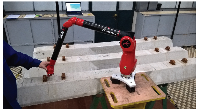
Rys. 4. Weryfikacja wymiarów podkładu strunobetonowego [fot. A. Aniszewicz]
