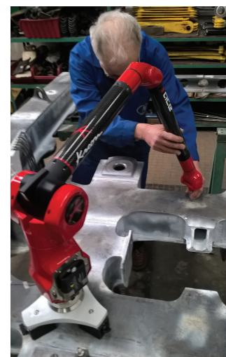
Rys. 6. Pomiary nowo zaprojektowanej ramy wózka podczas badań wytrzymałościowych: sprawdzanie naprężeń wewnętrznych i przemieszczeń w osiach x , y , z [fot. A. Aniszewicz]
