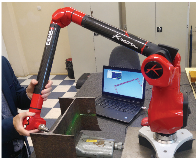
Rys. 1. Ramię pomiarowe podczas pomiaru elementu przekroju ostoi wagonu kolejowego [fot. A. Aniszewicz]
