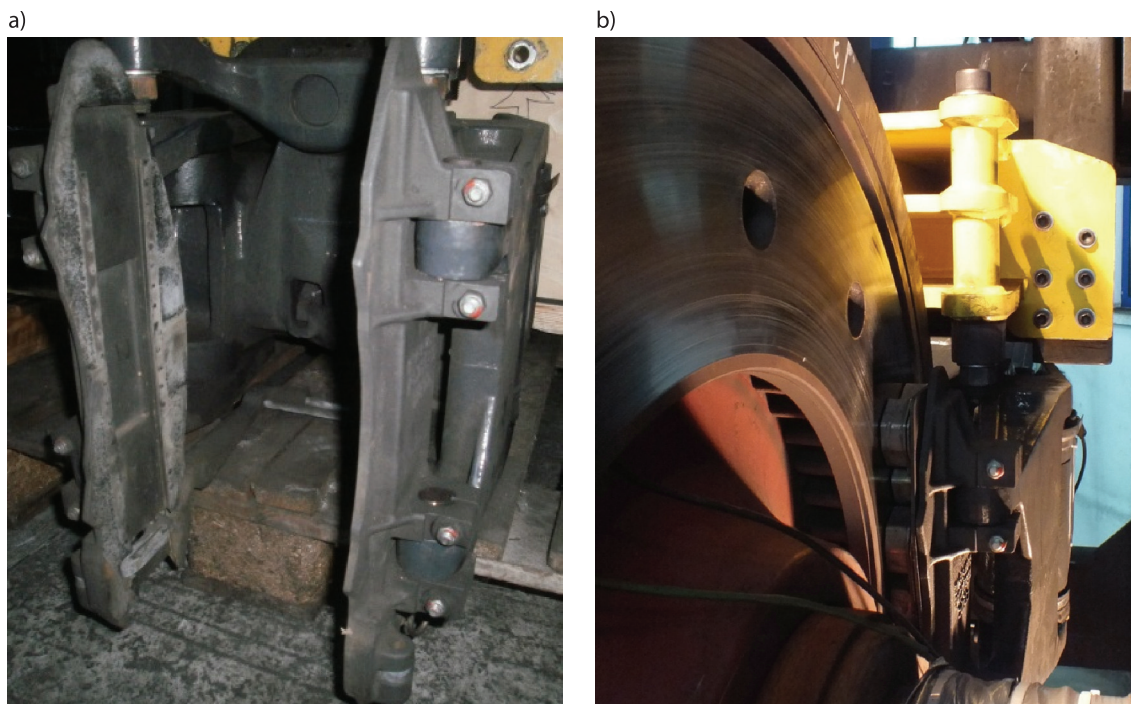
Rys. 3. Dodatkowa rama badawcza hamulca tarczowego: a) widok obsady hamulca, b) widok szczęki hamulcowej [fot. J. Kukulski]
