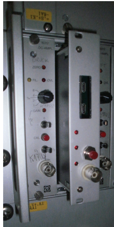
Rys. 7. Wkładka urządzenia pomiarowego ciśnienia identyfikującego wielkość siły [fot. J. Kukulski]
