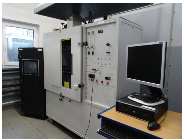
Rys. 2. Stanowisko do oznaczania gęstości optycznej dymu metodą testu jednokomorowego według normy PN-EN ISO 5659-2 [zbiory laboratorium IK]
