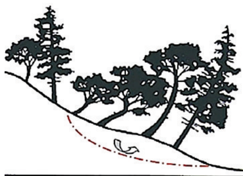
Rys. 5. Przykład charakterystycznego układu roślinności na skarpie wskazujący na zagrożenie osuwiskiem [25]
