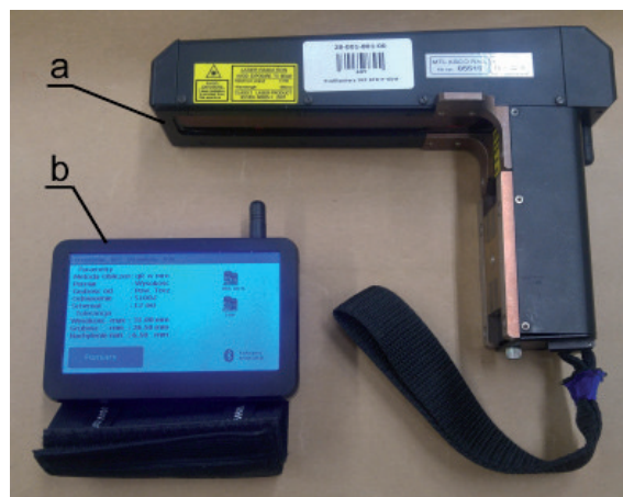
Rys. 4. Zestaw elementów profilomierza laserowego typu IKP-5 przeznaczony do pomiaru parametrów i zarysu profilu tocznego pojazdu kolejowego: a) moduł laserowy, b) minikomputer typu PDA [fot. A. Aniszewicz]
