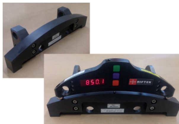
Rys. 2. Wzorzec kalibracyjny (wycinek walca): kalibracja średnicówki na ustalonej średnicy 850 mm [fot. A. Aniszewicz]
