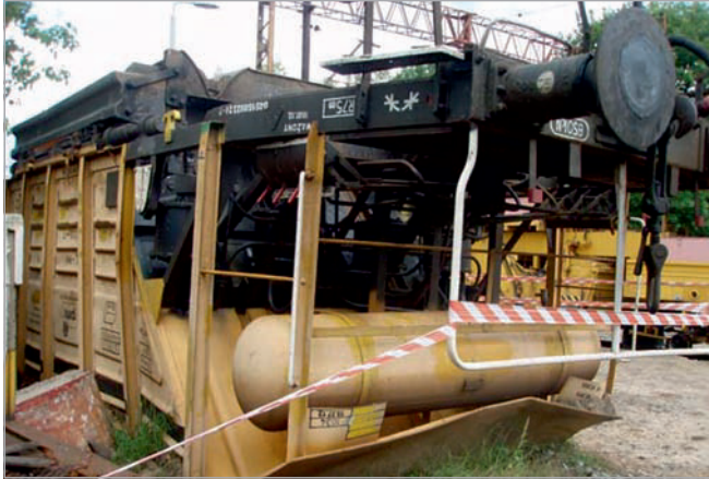
Rys. 2. Wykolejony wagon po zdarzeniu wypadkowym [fot. I. Mikłaszewicz]
