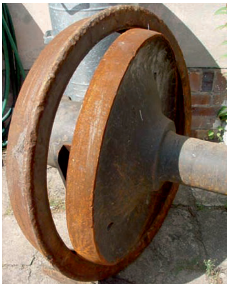
Rys. 3. Koło bosc z poluzowaną obręczą [fot. I. Mikłaszewicz]
