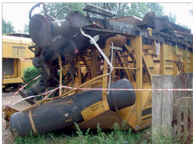
Rys. 1. Wykolejony wagon po zdarzeniu wypadkowym [fot. I. Mikłaszewicz]
