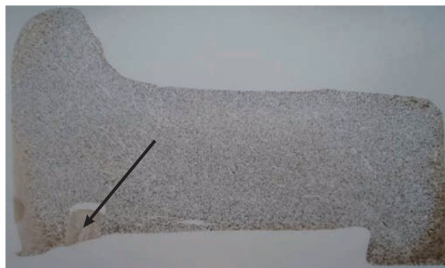
Rys. 5. Odbitka Baumanna obręczy z widocznym ścięciem pierścienia zaciskowego [fot. I. Mikłaszewicz]
