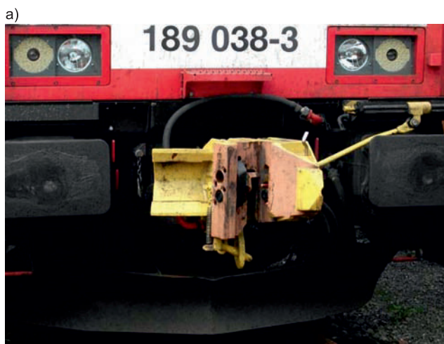
Rys. 13. a) Lokomotywa elektryczna klasy 189 wyposażona w sprzęg C-AKv [26], b) pierwsze cztery lokomotywy klasy 189 wyposażone w sprzęg C-AKv [27]
