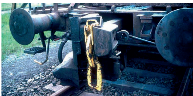
Rys. 9. Sprzęg samoczynny Intermat z elementem pośredniczącym (sprzęg mieszany) [21]
