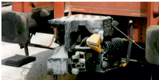
Rys. 11. Obłudzony sprzęg Z-AK wagonu DB AG (1998) [14]
