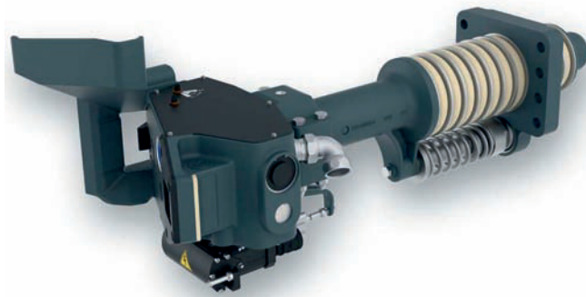
Rys. 18. Sprzęg samoczynny produkcji francuskiej [32]
