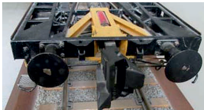
Rys. 6. Wagon platforma z zainstalowanym sprzęgiem samoczynnym UIC AK69 [14]
