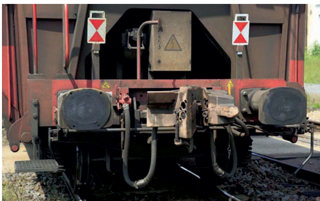
Rys. 12. Sprzęg samoczynny C-AKv zainstalowany w wagonie towarowym [25]
