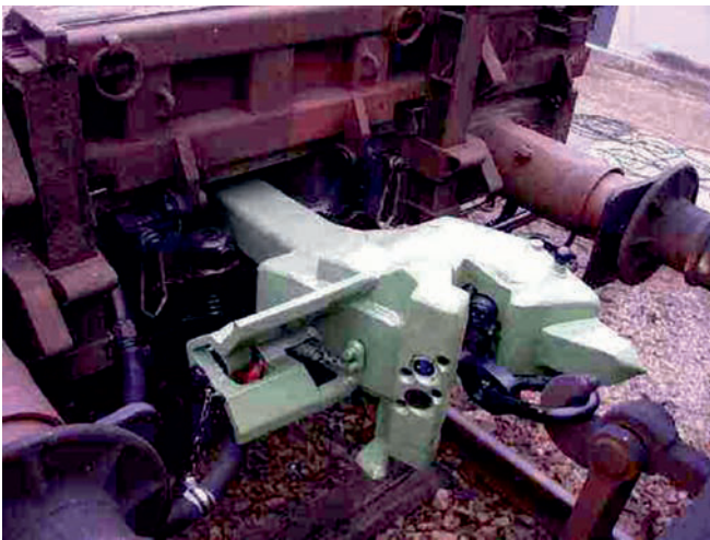
Rys. 14. Widok sprzęgu mieszanego typu C-AKv [28]
