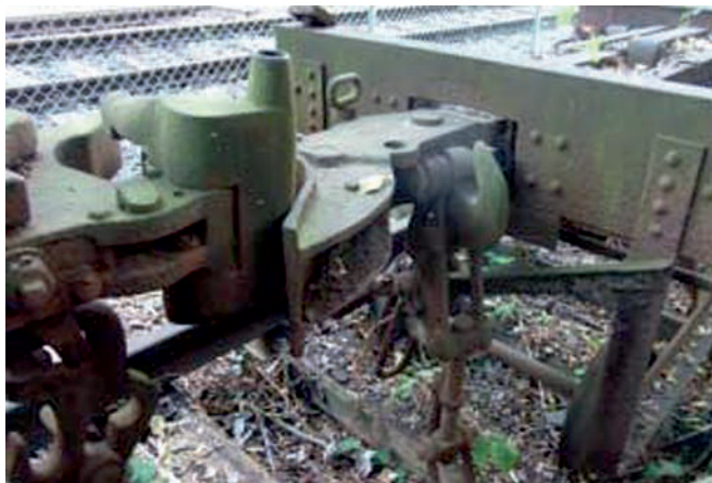
Rys. 2. Eksperymentalny sprzęg samoczynny z lat 20. XX wieku [14]
