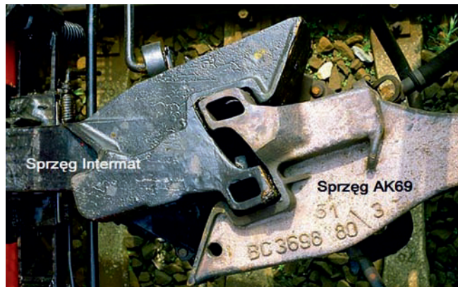
Rys. 7. Połączone sprzęgi Intermat i AK69 – widok z góry [19]
