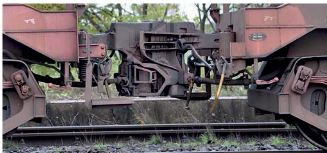
Rys. 8. Połączone sprzęgi UIC AK69 – widok z boku [20]
