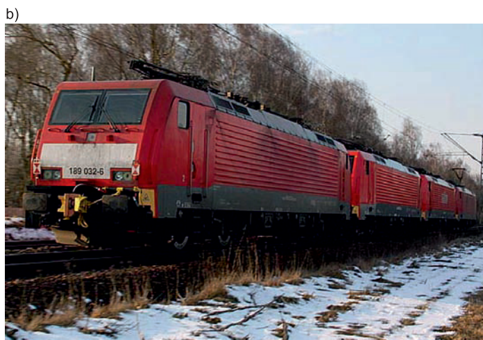
Rys. 13. a) Lokomotywa elektryczna klasy 189 wyposażona w sprzęg C-AKv [26], b) pierwsze cztery lokomotywy klasy 189 wyposażone w sprzęg C-AKv [27]
