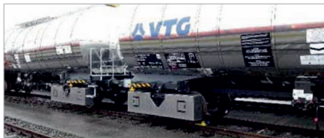
Rys. 11. Oszłona akustyczna wózka IWT cysterny [1]
