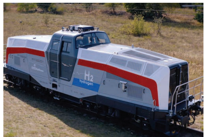
Rys. 4. Zeroemisyjna wodorowa lokomotywa manewrowa typu SM42-6Dn [6]
