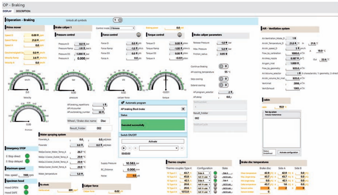
Rys. 12. Okno wyświetlanych podstawowych parametrów hamowania oraz wybranych parametrów systemu diagnostyki stanowiska w czasie rzeczywistym [opracowanie J. Kukulski]
