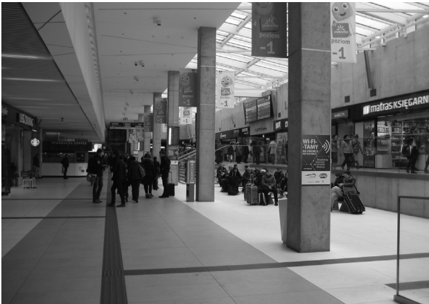
Rys. 3. Ścieżki dotykowe na dworcu w Katowicach [fot. Piotr Gondek]
