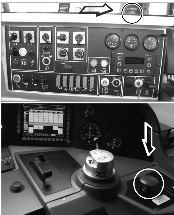
Rys. 10. Czerwony przycisk grzybkowy uruchamiający hamowanie nagłe i wyłączający lokomotywę [fot. A. Zbieć]
