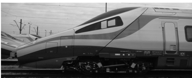
Rys. 4. Ukształtowanie czołowej części Pendolino zawierającej pochłaniacze energii [fot. A. Zbieć]
