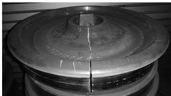
Rys. 8. Pęknięcie koła na skutek naprężeń temperaturowych [fot. A. Zbieć]
