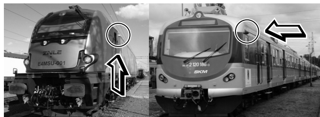
Rys. 16. Kamery zapewniające widoczność do tyłu [fot. A. Zbieć]
