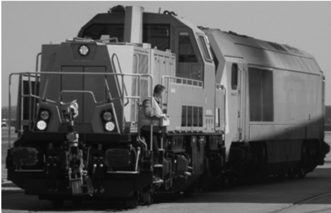
Rys. 18. Zdalne sterowanie pojazdem kolejowym podczas jazdy manewrowych [fot. A. Zbieć]
