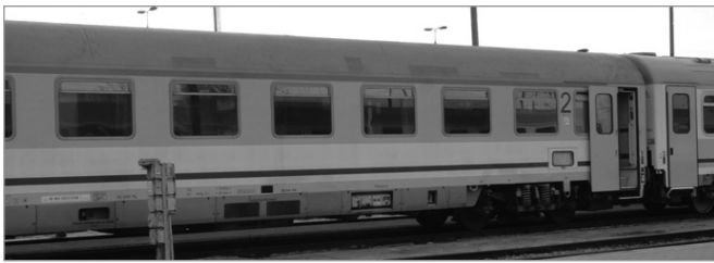
Rys. 13. Konstrukcja okien uniemożliwiająca przełożenie kuli o średnicy 10 cm [fot. A. Zbieć]
