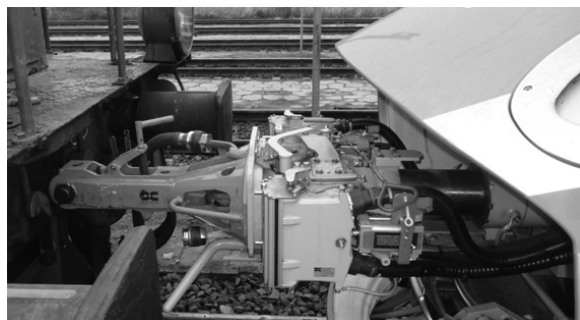
Rys. 1. Adapter (sprzęg) ratunkowy zamontowany w lokomotywie SM42 [fot. A. Zbieć]
