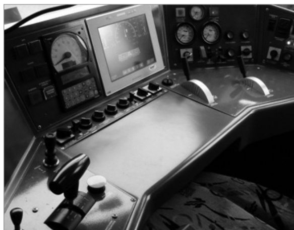
Fot. 17. Dźwignie trakcji (z lewej) i hamowania (z prawej) [fot. A. Zbieć]
