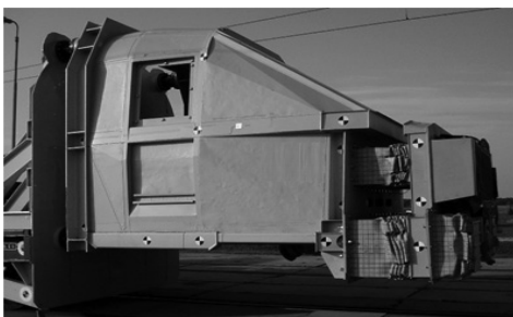
Rys. 3. Kabina pojazdu do prędkości V = 250 km/h: a) przed zderzeniem, b) po zderzeniu [fot. A. Zbieć]
