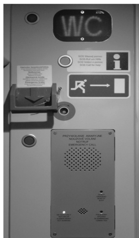
Rys. 11. Alarm dla pasażerów i urządzenia systemu komunikacji głosowej [fot. A. Zbieć]
