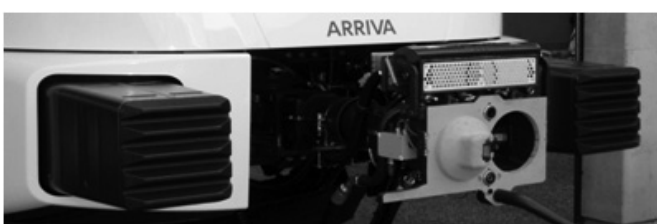
Rys. 5. Antywspinacze zabezpieczające przed wspinaniem się pojazdów [fot. A. Zbieć]
