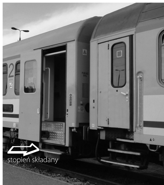
Rys. 12. Budowa stopni i umieszczenie uchwytów w wagonach nowej i starej konstrukcji [fot. A. Zbieć]
