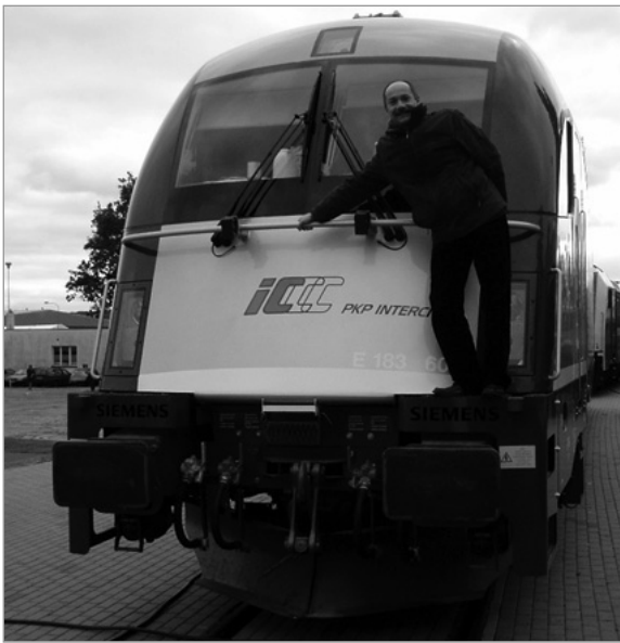
Rys. 20. Możliwość czyszczenia przedniej szyby kabiny maszynisty [fot. A. Zbieć]
