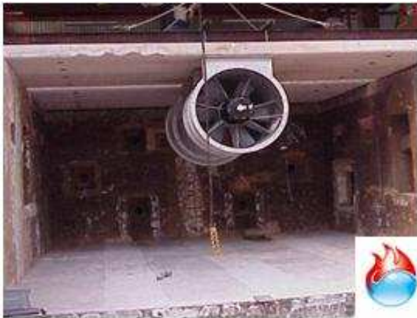
Préparation de l'essai de tenue au feu d'un accélérateur à la station d'essai d'EFFECTIS France à Maizières-Lès-Metz
