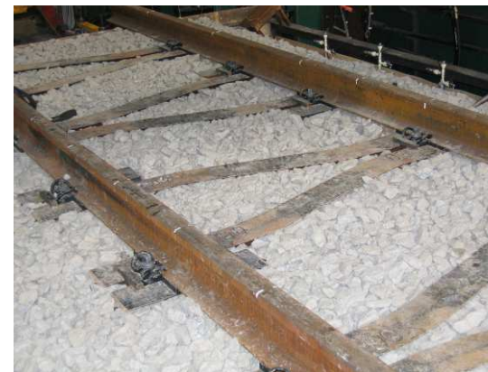
Rys.14 Widoczny odcinek toru typu Y na stanowisku badawczym
