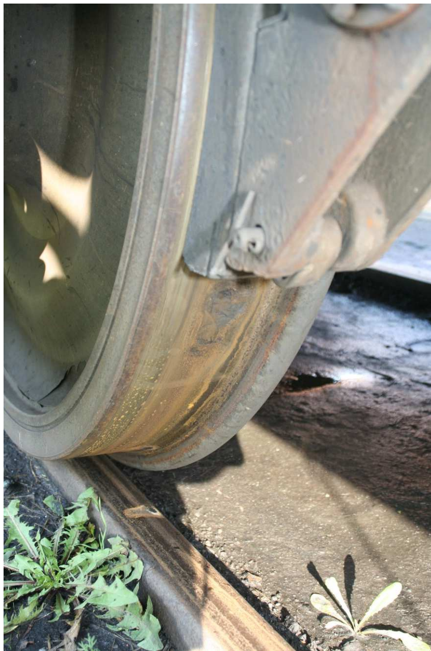
Rys.34-36 Uszkodzona powierzchnia toczna koła
