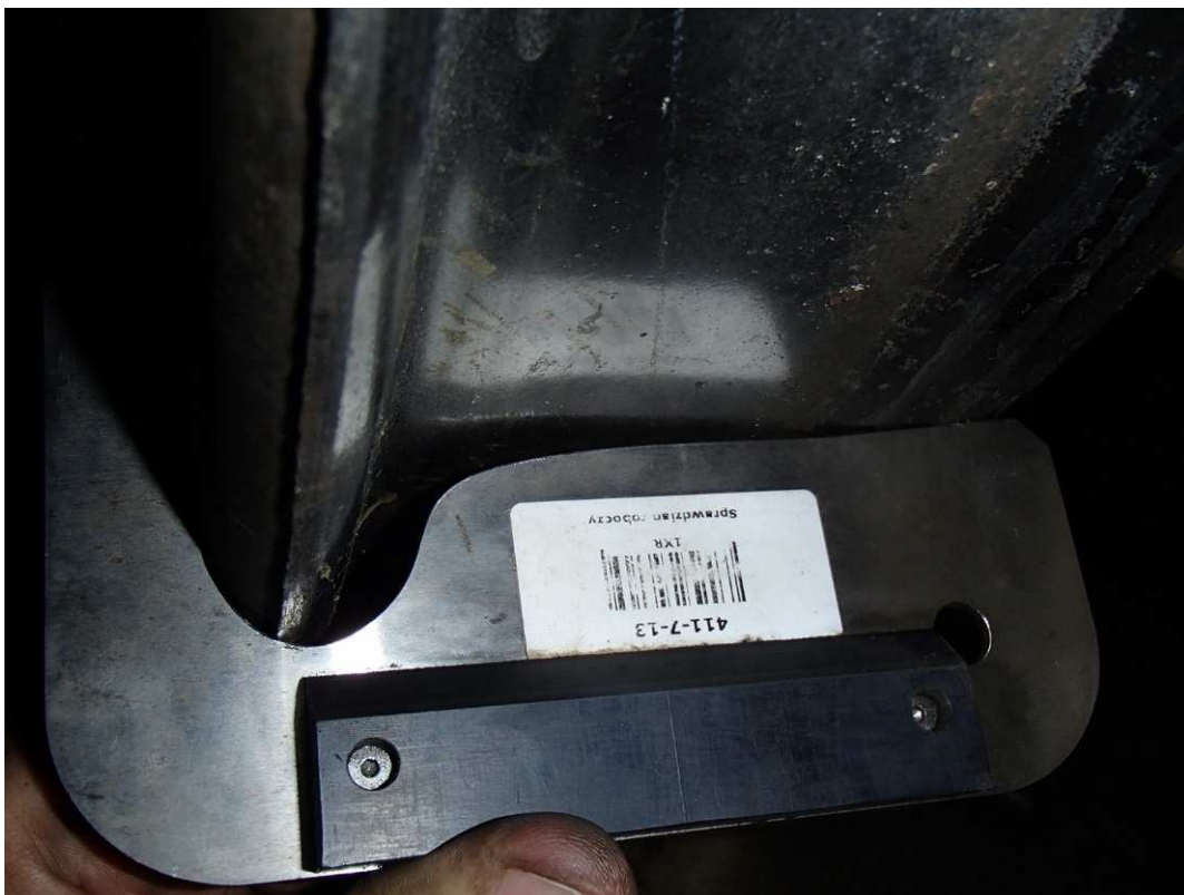
Rys.31 Zużyte obrzeże zestawu kołowego
