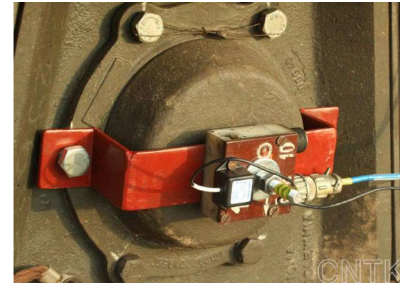
Rys.24 Czujniki przyspieszeń zamontowane na obudowie łożyska autobusu szynowego
