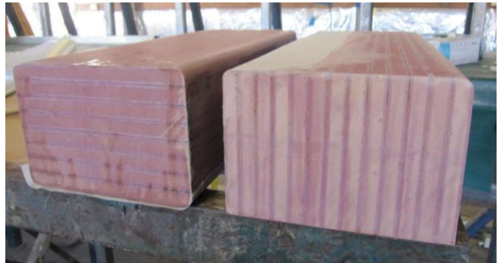
Podkład z laminatu kompozytowego [7]
