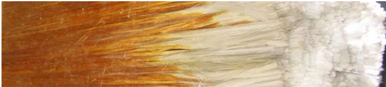
Budowa kompozytu FFU firmy Sekisui. (Materiały promocyjne Sekisui)
